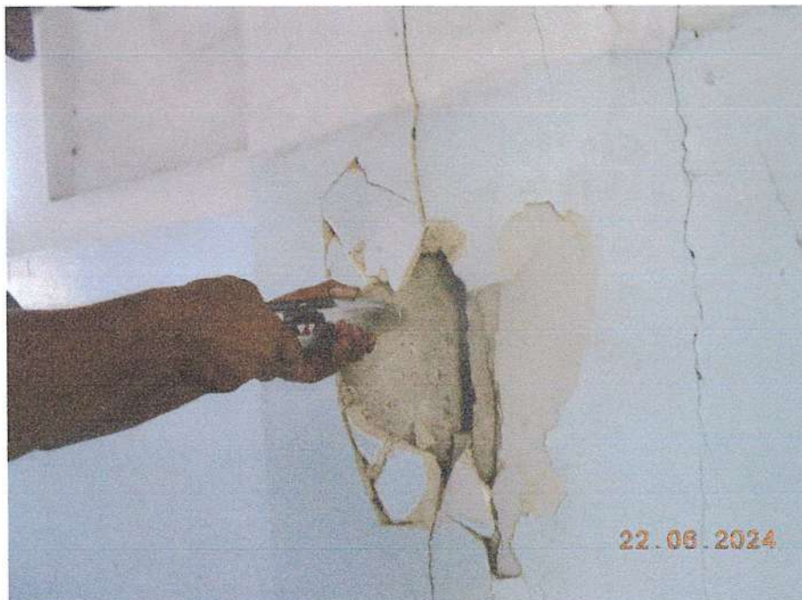
Նկ. 5 Մասնաշենքի երկաթբետոնե կոնստրուկցիաների ամրության որոշման գործընթացը
